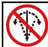
Non installare in posizione inclinata
