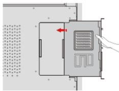
**Passo 3:** Fissare il PC interno al display con le viti M3.
